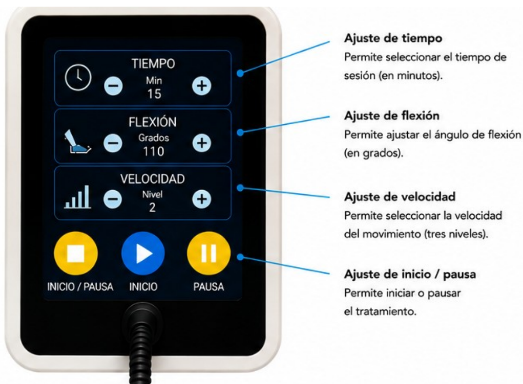
Control del CPM: tiempo, flexión, velocidad e inicio/pausa.
